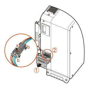
Figure 5-2 loosen the wiring of fan module
