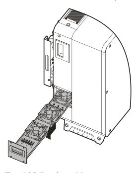
Figure 5-3 Pull out fan module
